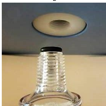
Рисунок 19. Установка 0,22 мкм фильтра диспенсера.
