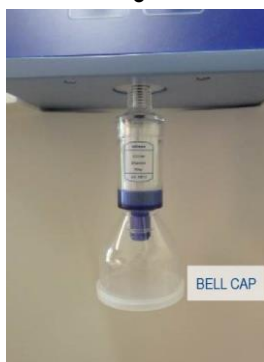
Рисунок 19. Установка 0,22 мкм фильтра диспенсера.
