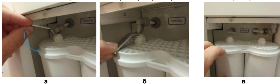
Рисунок 33. Замена модулей тонкой очистки и деионизации.
